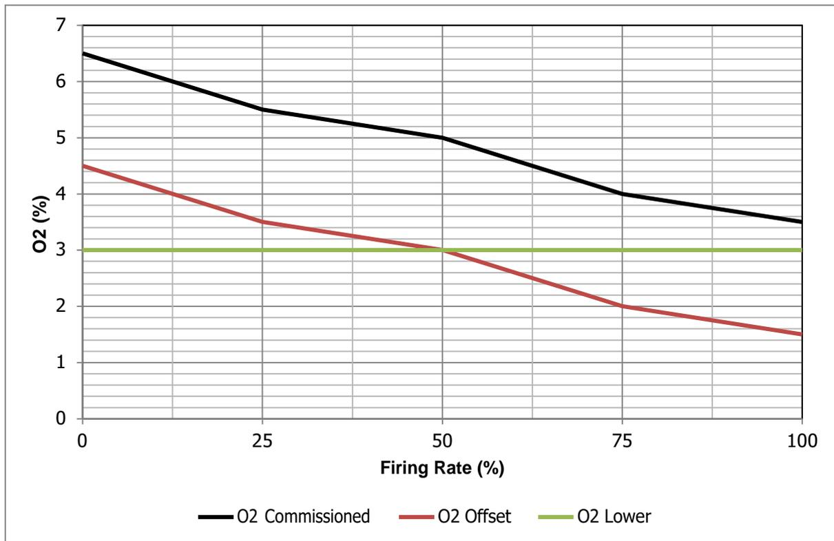
Figure 4.5.1.i O<sub>2</sub> limits example
